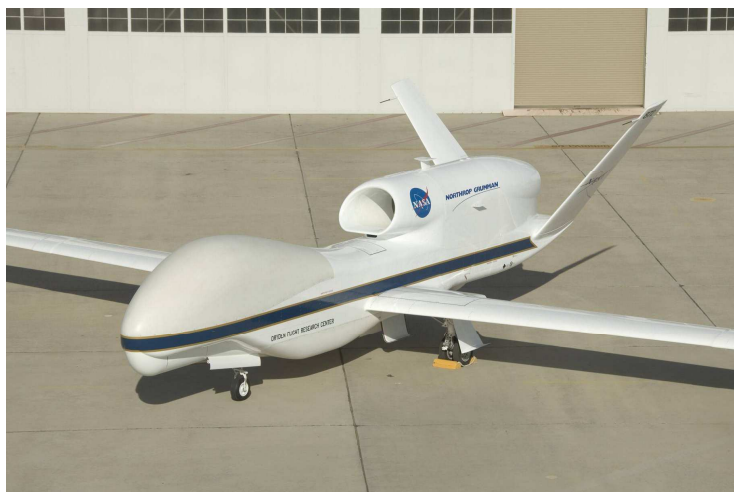
Figura 6.7 – Global Hawk aereo stratosferico (fino a 20 Km di quota) senza pilota di proprietà della NASA, capace di fare voli con durata fino a 30 ore, diventato recentemente disponibile per applicazioni scientifiche
