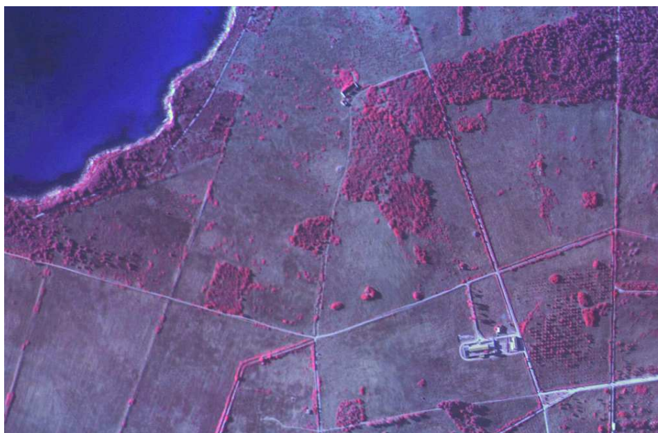
Figura 3.10 - Immagine in falsi colori di una zona dell'Isola di Pianosa ottenuta da piattaforma aerea con una camera multispettrale VIS-NIR. L'immagine evidenzia il livello di risoluzione spaziale che può essere raggiunto con sensori aerotrasportati nello studio delle caratteristiche spettrali della vegetazione, anche in territori complessi come quelli tipici dell'area mediterranea
