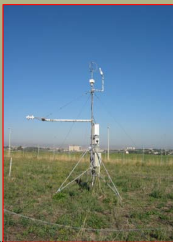
Stazione micrometeorologica per la misura dei flussi turbolenti di calore, umidita' e momento Stazione radiometrica per la misura del bilancio radiativo
