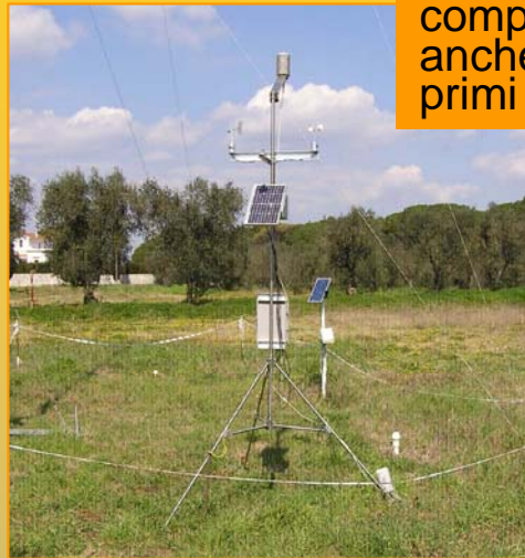
La stazione (h=16 m ) per la misura dei flussi turbolenti e il bilancio di momento e di vapore acqueo scambiati tra la superficie e l'atmosfera
