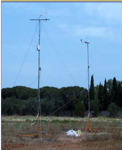
Stazione micrometeorologica (h=10 m) per la misura dei flussi verticali turbolenti di aerosol (PM2.5) e di gas serra (CO 2 )
