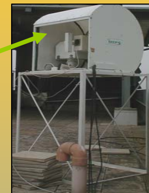
Il radiometro MTP5-P misura la radiazione termica emessa dall'ossigeno molecolare nella banda delle microonde (60.4 GHz) e fornisce il profilo di temperatura da 0 a 600m
