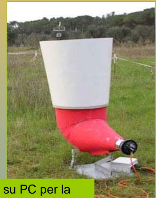
Il Sodar Doppler REMTECH PA1 misura il profilo verticale delle tre componenti della velocità del vento
