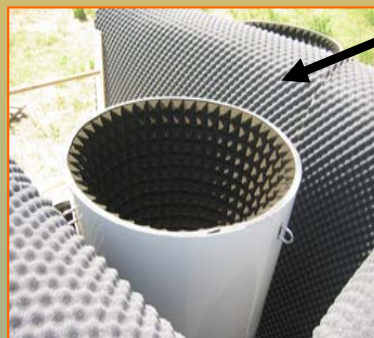
Minisodar VHR-MTS e' un sensore di telerilevamento acustico per la misura ad alta risoluzione della struttura termodinamica dello strato superficiale da 4 a 100 m.
