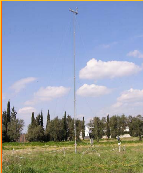
La stazione (h=16 m ) per la misura dei flussi turbolenti e il bilancio di momento e di vapore acqueo scambiati tra la superficie e l'atmosfera
