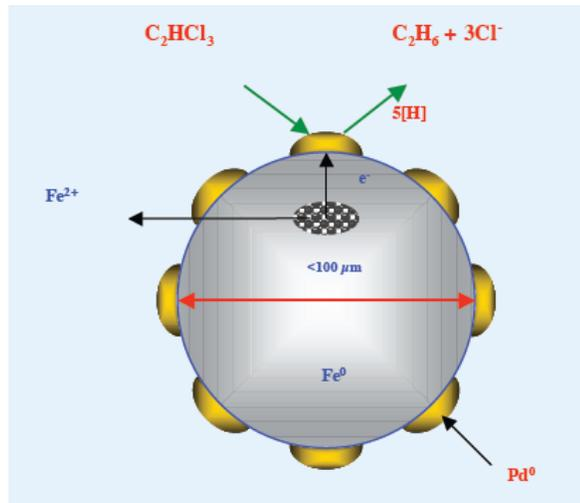
Nanocatalizzatori ad alta efficienza e basso costo per l'utilizzo in reattori ed in campo (es. risanamento acque di falda).
