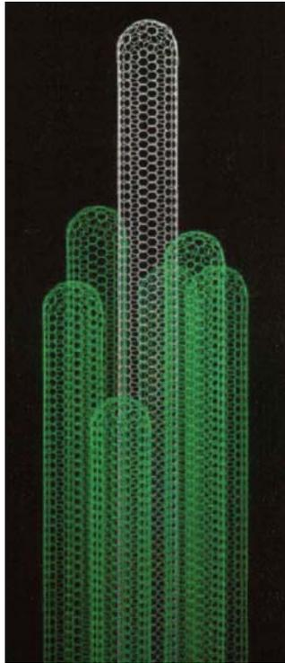
Nanotubi e materiali nanocompositi per l'adsorbimento selettivo di arsenico, metalli, diossine, ecc.
