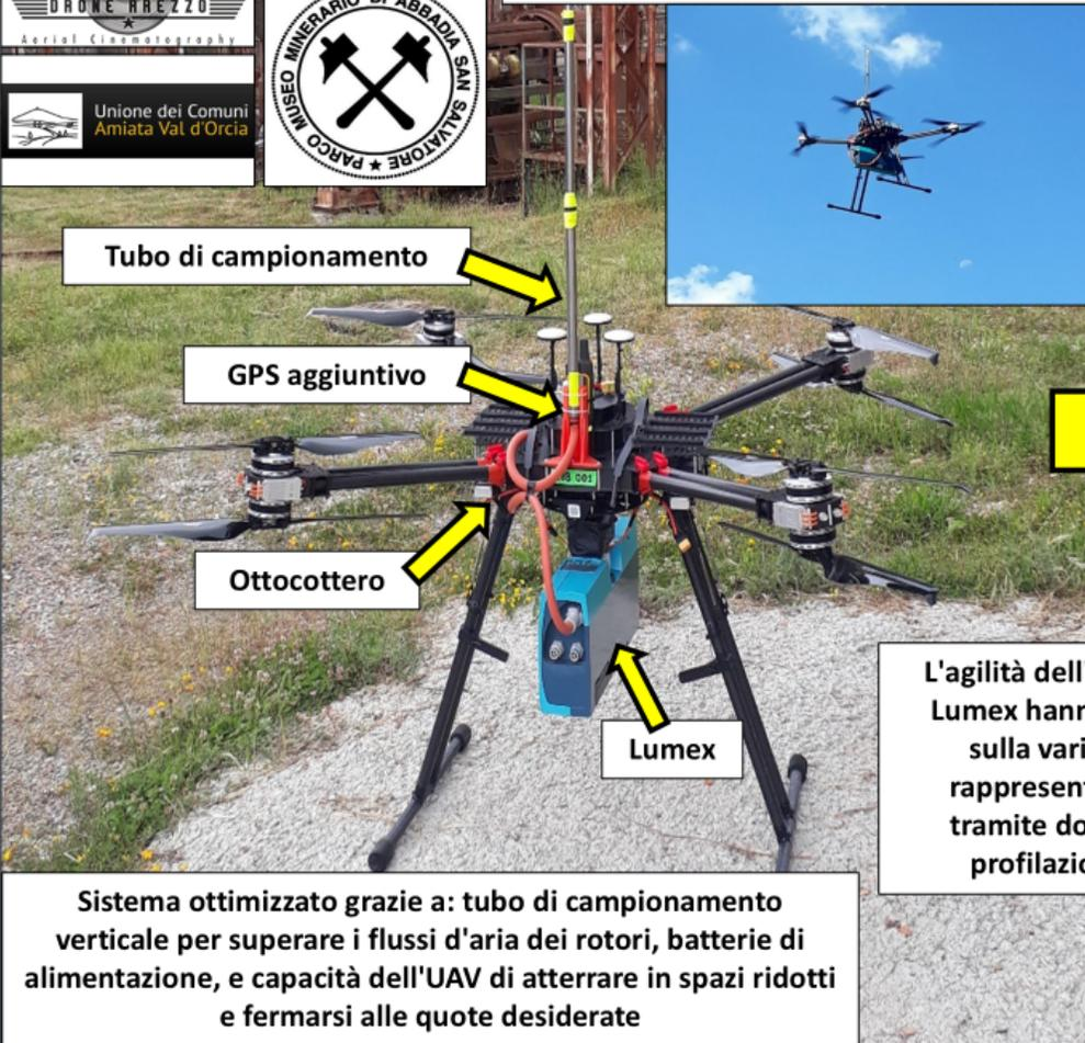
Sistema ottimizzato grazie a: tubo di campionamento verticale per superare i flussi d'aria dei rotori, batterie di alimentazione, e capacità dell'UAV di atterrare in spazi ridotti e fermarsi alle quote desiderate
