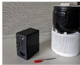
Sistema di monitoraggio di inquinanti indoor con sistema automatico di abbattimento
