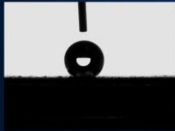
Goccia di acqua di mare sul rivestimento siliconico antifouling, mostrato in B
