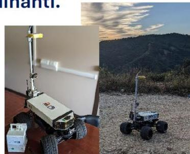
Drone per il monitoraggio di inquinanti gassosi e solidi aerodispersi per il controllo di siti contaminati
